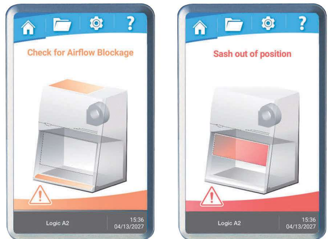
Sash Alarm display on Logic OS.
