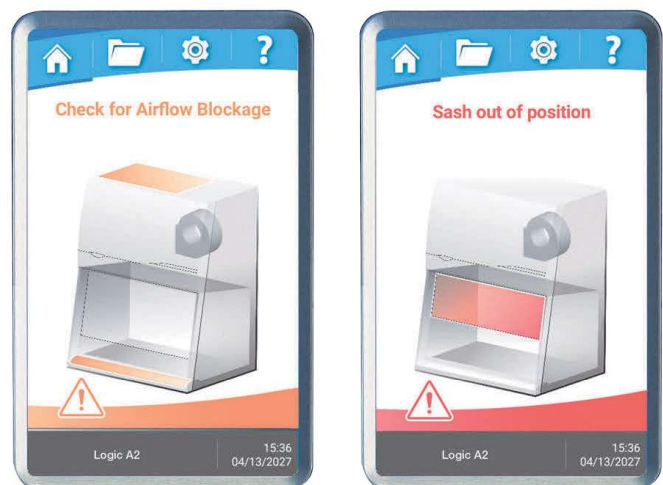
Sash Alarm display on Logic OS.
