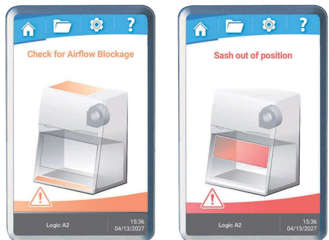
Sash Alarm display on Logic OS.
